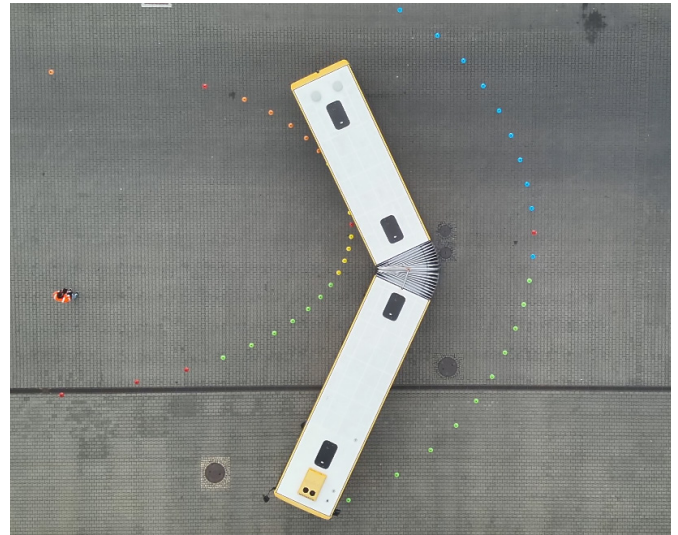
Abb. 6: Schleppkurven-Versuchsfahrt mit dem MB CapaCity L.
